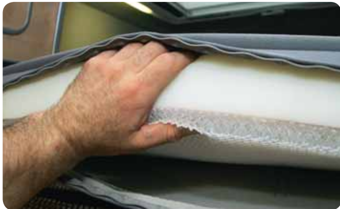
Ungewöhnlich, aber wirksam: Das Dachbett verzichtet auf einen Lattenrost. Ein Abstandsgewirke sorgt für Unterlüftung und Liegekomfort.
